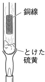
(8) 右の図のように硫黄の蒸気の中に熱した銅線を入れたときにできる物質を何といいますか。
